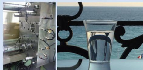
「ポリ乳酸の薄肉射出成形技術」により実現した世界最薄 0.65 mm厚の透明カップ（写真右）と、1回で多数個成形可能な金型工法（写真左）。CO<sub>2</sub>をポリ乳酸に超臨界状態で大量溶解させ、流動性を著しく向上させることで実現
