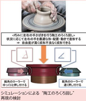
シミュレーションによる“陶工のろくろ回し”再現の検討
