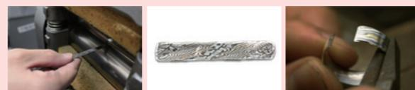
7. 圧延し6. を繰り返す 8. 適正寸法まで圧延 9. リング状に形成
