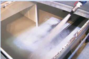
微細な粒子のシャーベット氷で魚体を傷付けず包み込み急速冷却
