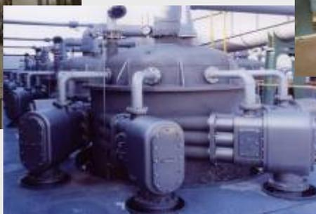
微細化したインクを効率的に気泡に吸着させ、その気泡とともに高効率で除去できる装置を開発したことにより、漂白工程が不要となり、使用水量を極度に減らすことが可能となった
