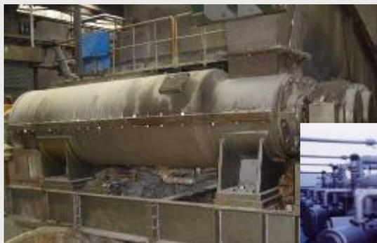
繊維同士の摩擦力を利用してインクを微細かつ均一に離解することにより、従来の処理方法より効率的にインクを除去するプロセスを開発
