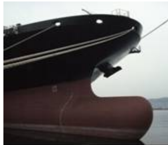
高度なぎょう鉄技能が必要となる船主部分
